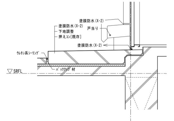
E断面詳細図（西側6階壁面取合い）
