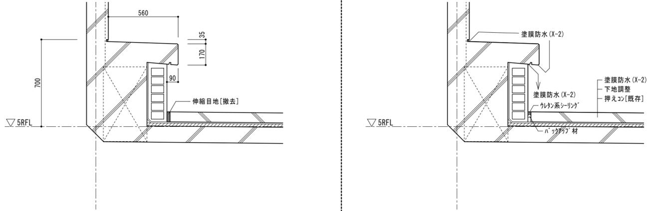
F断面詳細図（折板屋根取合い）
